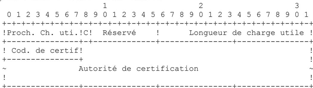
Figure 13 : Format de charge utile Demande de certificat
