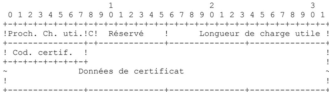
**Figure 12 : Format de charge utile de certificat**
